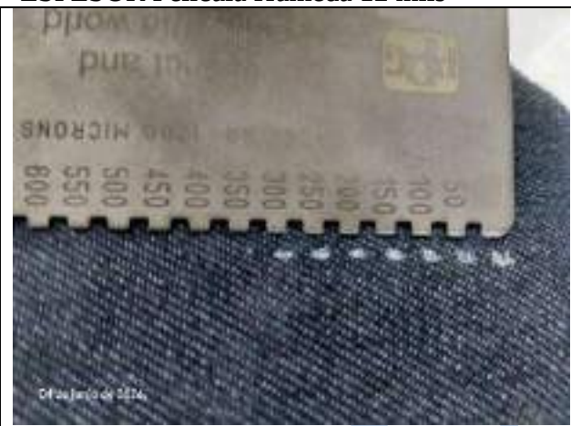
ESPESOR Pelicula Húmeda 12 mils
