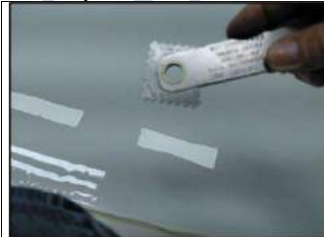
Medición Espesor Pelicula Húmeda 30 mils
